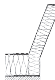
Stahl-Alu-Verbund Aufsetzkranz Typ AK, 40 cm hoch
