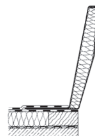
Stahl-Alu-Verbund Aufsetzkranz für RWA Typ RAK, 30 cm hoch
