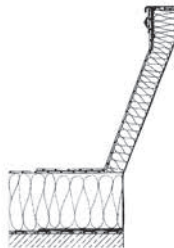
Metall-Aufsetzkranz Typ TE, 40 cm hoch mit E-Klemmschiene
