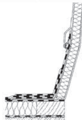
GFK-RAK für RWA mit optionaler GFK-Schürze (Überhangstreifen)
